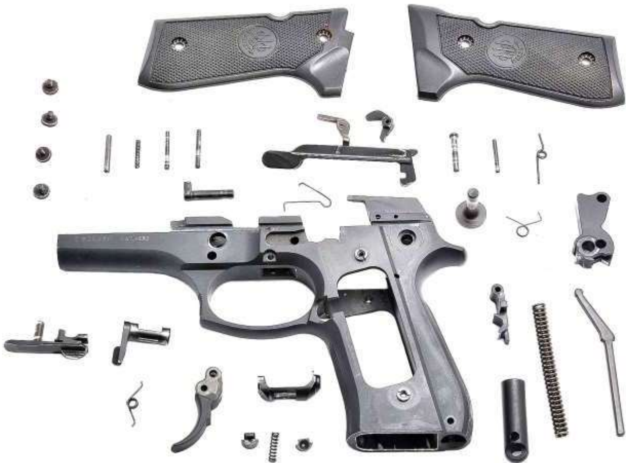
Nella foto lo smontaggio completo del fusto di una pistola Beretta mod. 92/98 FS
