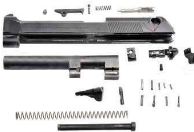
Nella foto lo smontaggio completo di un carrello della pistola Beretta mod. 92/98 FS
